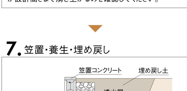
笠置コンクリートを打設して下さい。(防水モルタル)その後、コンクリートの養生を行い、透水層を設置しながら埋め戻しを行ってください。
